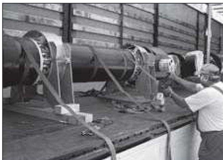
Hollandiából kamionnal érkezett a felújított munkahenger
